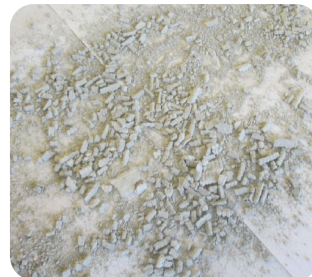
④ウェーブネットからセメントモルタルを分離。
