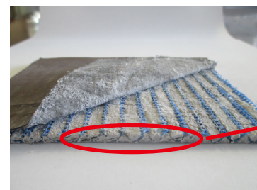
硬化後の内部状況
