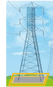
送電塔周辺の浸食部
