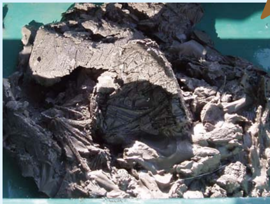
乾燥した汚泥を袋から出した状態
