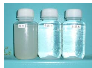
原水、ろ過水状況
